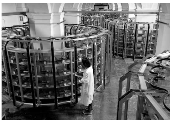
Fig. 1. Apparato espositivo per lo studio degli effetti cancerogeni del campo magnetico -50Hz
