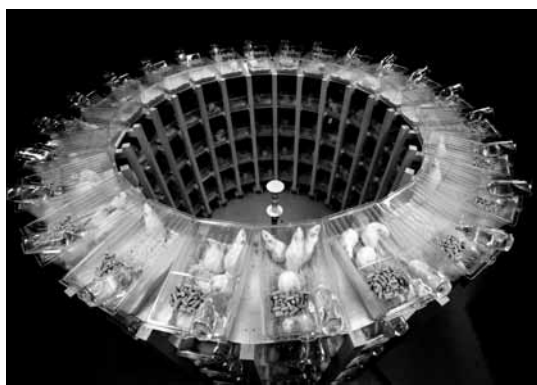
Fig.2. Apparato espositivo per lo studio degli effetti cancerogeni del campo elettromagnetico a RF delle stazioni radio-base della telefonia mobile
